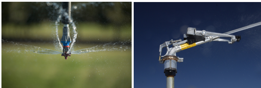
Fig. 6. Tipuri de duze utilizate la sistemele de irigare cu pivot central ( https://en.wikipedia.org/wiki/Center_pivot_irrigation )
