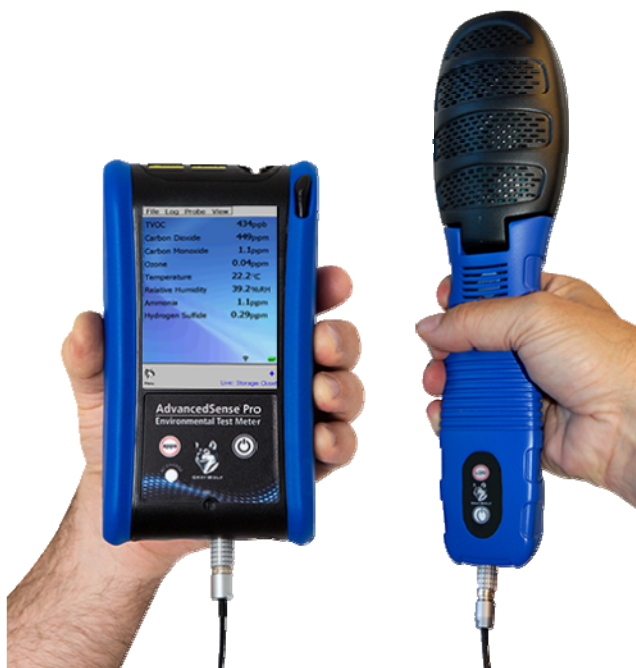
Fig. 3. Sondele inteligente DirectSense II și contoarele AdvancedSense de la GrayWolf
